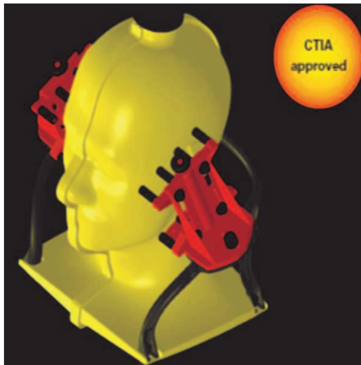
FIGURE 1: SAM-Modellpuppe Quelle: Speag Phantom Produkt-Flyer. "CTIA" steht für "Cellular Telecommunications Industry Association".
